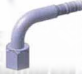
Końcówka z gwintem wewnętrznym UNF, typ SAE, stożek 45°
